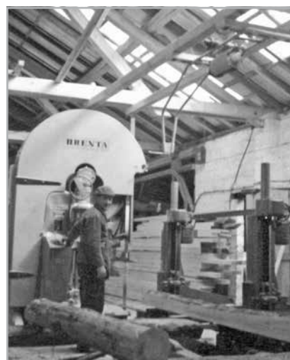
Aloys Weber an der Blockbandsäge (1960er Jahre). Damals gab es noch keine Förderbänder, so dass alles per Hand geleistet werden musste.
